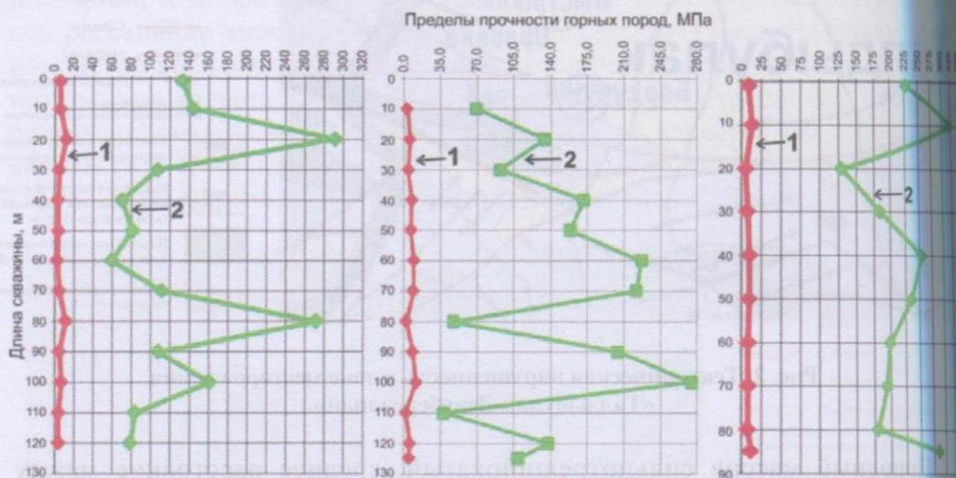
Рис. 4. Изменение прочностных свойств горных пород с глубиной:
